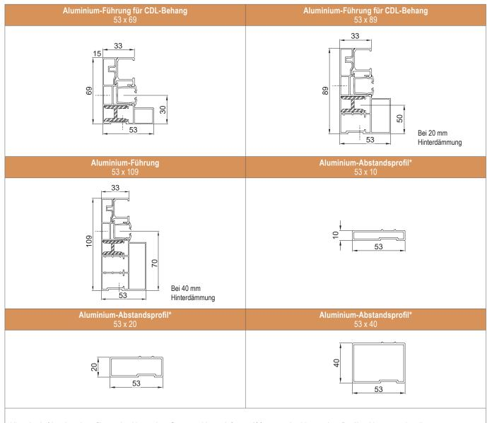
Hinweis: Aufdopplungdsprofile werden bis zu einer Gesamtschienentiefe von 109 mm werkseitig montiert. Darüber hinaus werden die Profile ungebohrt und einzeln ausgeliefert. Abstandsprofile können nicht von unten geschlossen werden und haben, wenn lose ausgeliefert, keinen Führungsschienenschrägschnitt.
