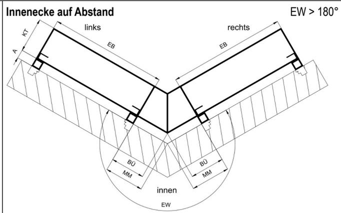
EW = &lt; 180°, EB = Elementbreite, BÜ = Blendenüberstand, MM = Maß Mauerwerk, EW = Eckwinkel (Montagefläche zu Montagefläche), KT = Kastentiefe
