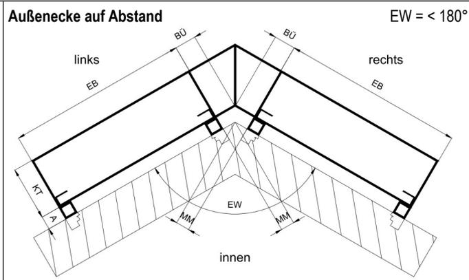
EW = &lt; 180°, EB = Elementbreite, BÜ = Blendenüberstand, MM = Maß Mauerwerk, EW = Eckwinkel (Montagefläche zu Montagefläche), KT = Kastentiefe
