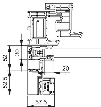
1. Führungsschiene PUKA II RA Rollladen Außenrevision 90er Öffnung
