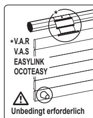
**Voraussetzung:** Das Drehmoment des Motors muss passend zum Rollladen ausgewählt werden. Keinen zu starken Motor verwenden. Für weitere Informationen zur Kompatibilität des Antriebes mit dem Rollladen und dessen Zubehör, wenden Sie sich an den Rollladen-Hersteller oder SIMU.
