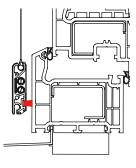
Standard-Bürstenposition in der IS-Aluminium-Endleiste
